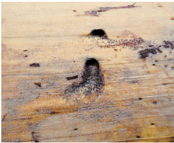
Bockbefall bedeutet Brennholz: Die Bohrlöcher von Bockkäfern sind mit 2 bis 8 mm Durchmesser zu groß und auch zu lang für Bau- und Schnittholz. Die Bohrlöcher der Holzwespe können sogar 40 cm lang werden.
